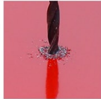
...boor de gaten op lage snelheid (max 500 rpm).
